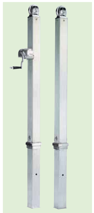
■ステンレステニス支柱 角型 6-21-417 廃番 主材φ75SUS 埋込部40cm 専用SUSウインチ付 26.5kg ※6-22-113が専用埋込管となります。
