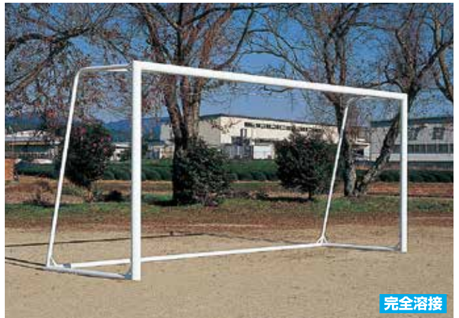
■少年サッカーゴール スチール製(対) 3-21-261 本体¥330,000(税込¥363,000) 間口2.15×5m 全奥行上0.92下1.8m 101.6丸鋼管 杭8本付 ネット別 119kg/台 3-21-271 本体¥320,000(税込¥352,000) 間口2.15×5m 全奥行上0.9下1.78m 76.3丸鋼管 杭8本付 ネット別 97kg/台
