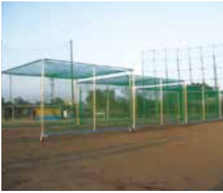
パイプにボールが当たらない様に柵とネットを離れたゲージ
